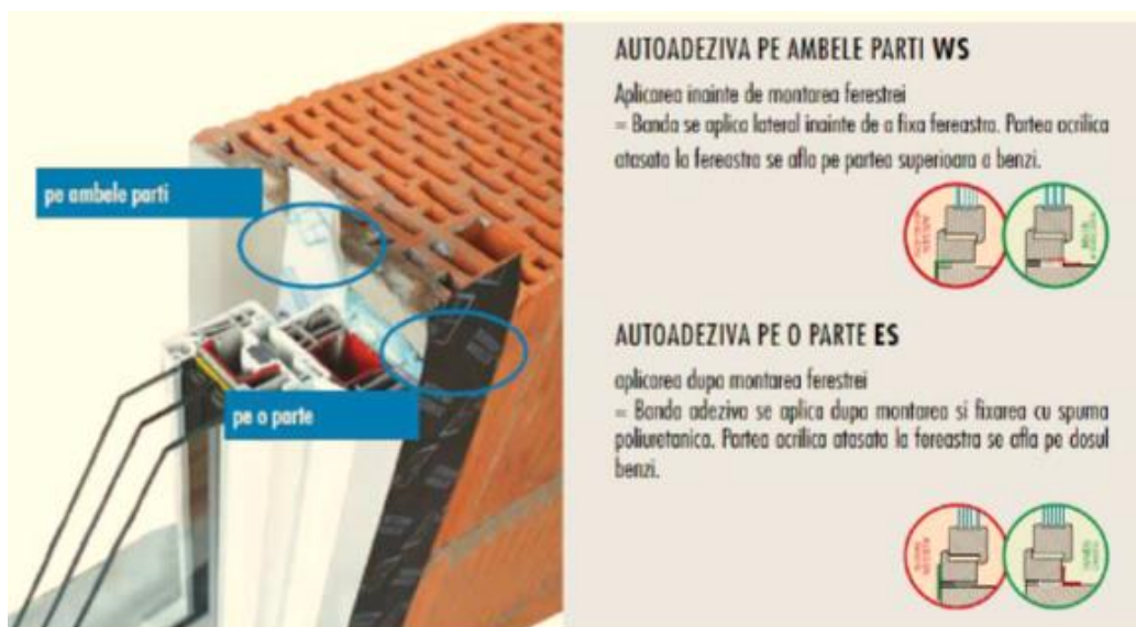
Figura 27 Soluție de etanșare cu benzi
